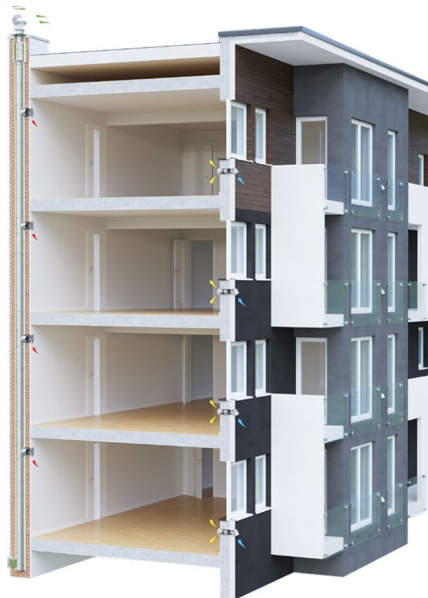
System wentylacji hybrydowej jednorurowej
