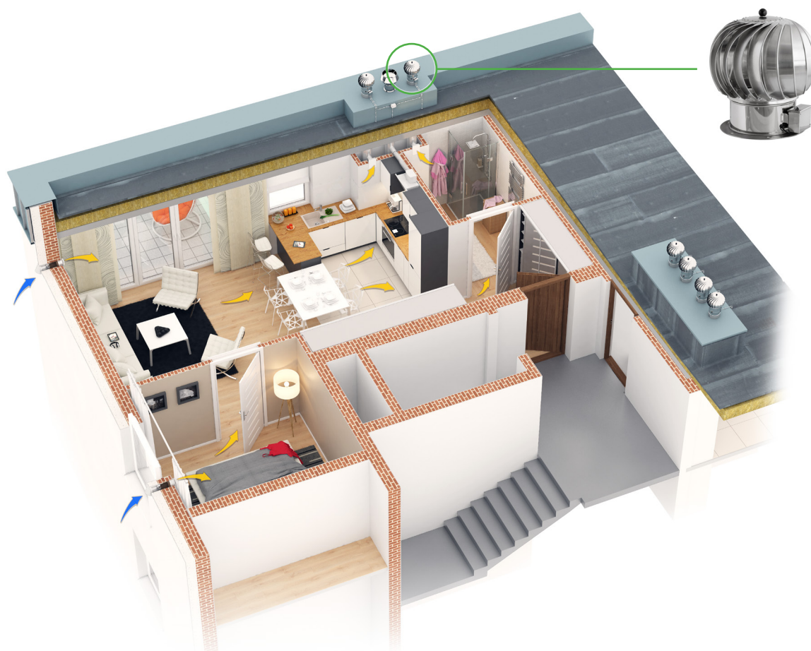
Mieszkanie - zapewnienie ciągu kominowego: dobór nasady Turbowent.
