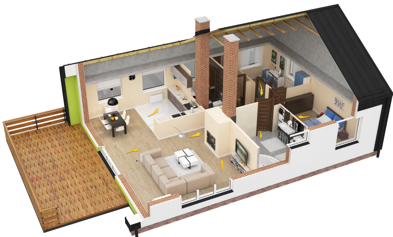
Dom jednorodzinny - prawidłowy kierunek przepływu powietrza.
