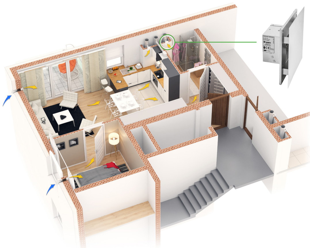
Mieszkanie - lokalizacja wywiewu i dobór Stabilików.
