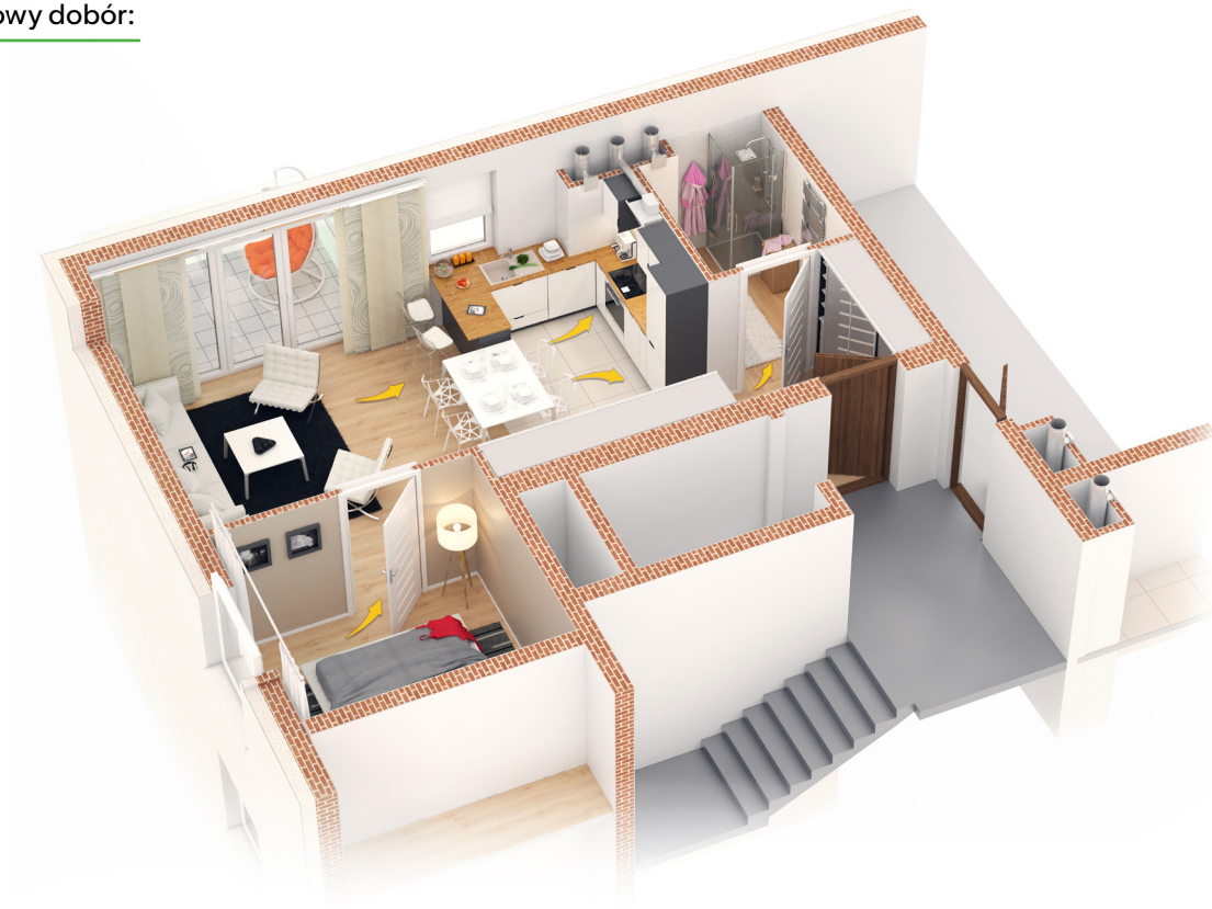
Mieszkanie - prawidłowy kierunek przepływu powietrza.
