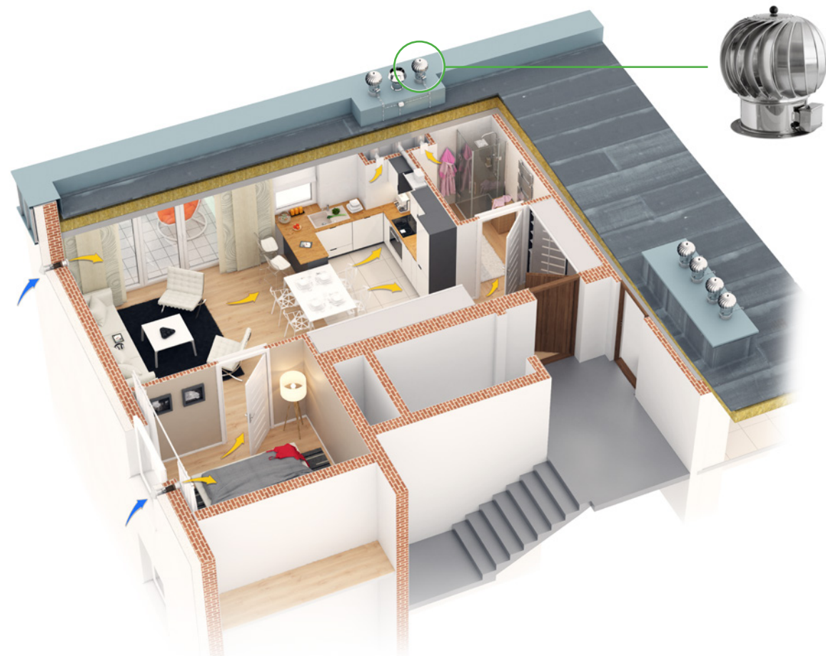
Mieszkanie - zapewnienie ciągu kominowego: dobór nasady Turbowent.
