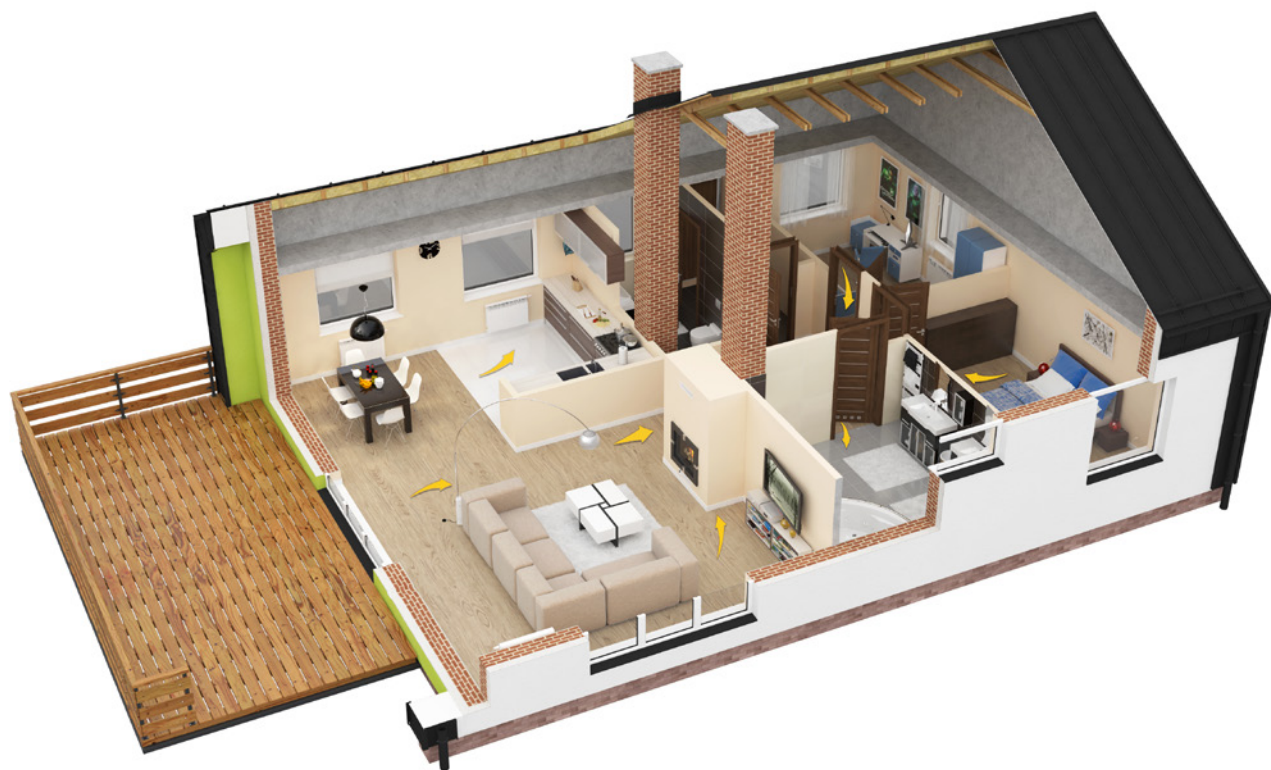
Dom jednorodzinny - prawidłowy kierunek przepływu powietrza.
