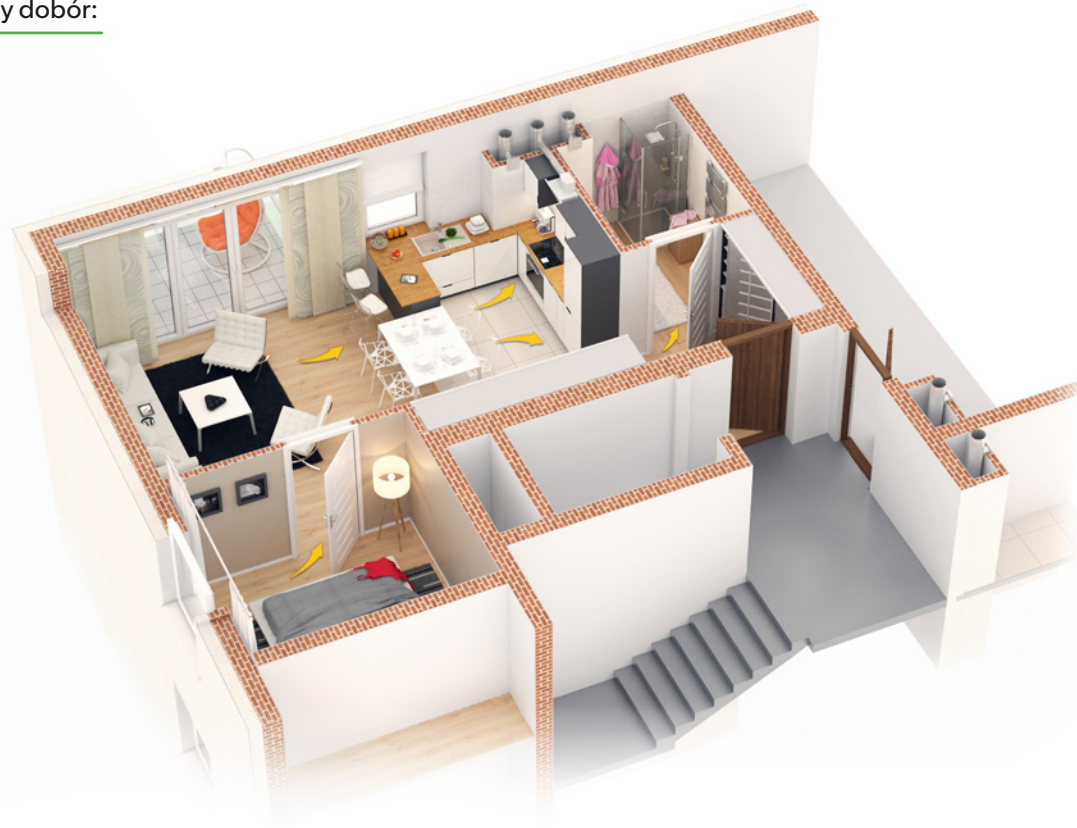
Mieszkanie - prawidłowy kierunek przepływu powietrza.
