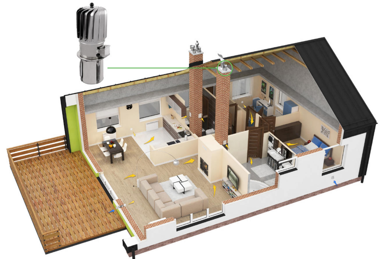
Dom jednorodzinny - zapewnienie ciągu kominowego: dobór nasady Turbowent.
